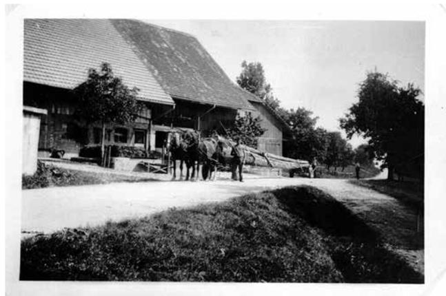
*Pferdefuhrwerk mit Langholz vor 1950. Die Ketten umwinden die Ladung und sind mit «Brüechbengeln» gespannt. Der «Wepfer» steuert hinten die Fuhrre um die Kurven herum.*
